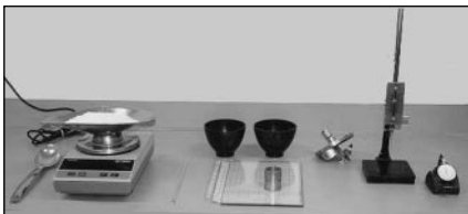
Figura 1 - A) Bilancia con il refrattario, B) Termometro, C) Recipienti di gomma, D) Attrezzatura per la prova di assetto, E) Agitatore per miscelare, F) Ago di Vicat, G) Cronometro
