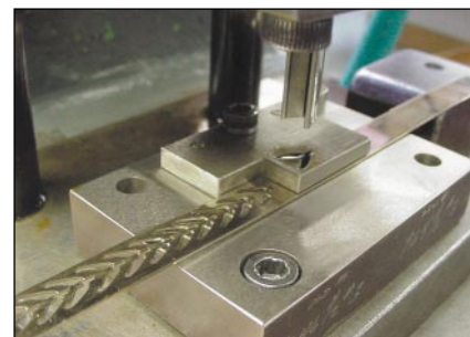
Figura 10 - L'utensile finito per la tranciatura del castone a sei graffette, montato con lo stampo, è in funzione
