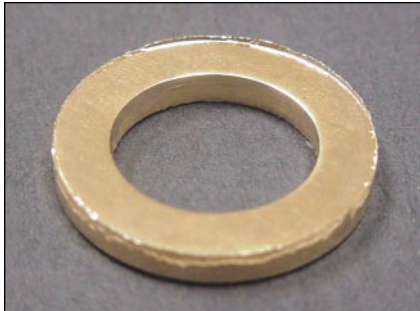
Figura 6 - Questo sbizzoso di fede nuziale è un buon esempio di gioco inadatto tra punzone e stampo. Notare la vistosa bava lungo il bordo esterno
