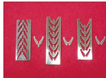
Figura 11 - I tre pezzi tranciati necessari per montare il castone a sei graffette ed i resti del nastro tranciato per ciascuno di essi
