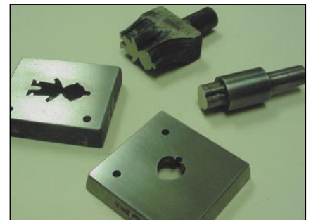
Figura 7 - Tipica attrezzatura per tranciare ciondoli costruita a mano. Per rimuovere il rottame, fa uso di un estrattore collegato alla pressa
