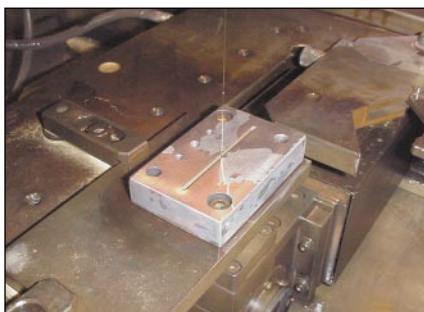
Figura 9 - Le attrezzature sono tagliate con una macchina EDM a filo, con una tolleranza di 0,005 mm
