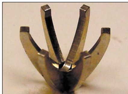
Figura 2 - Tipico castone a sei graffette. Notare che l'assenza di lega per saldare nel giunto permette di vedere l'incastro di intagli che tiene insieme il castone
