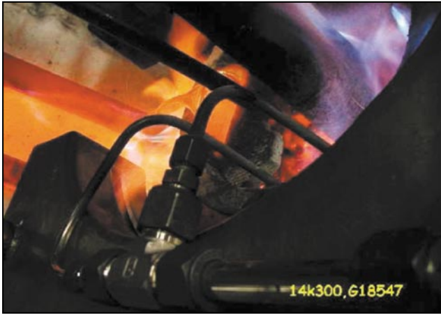
Figura 5 - Produzione di graniglia per colaggio in oro giallo a 14 K alla Stuller
