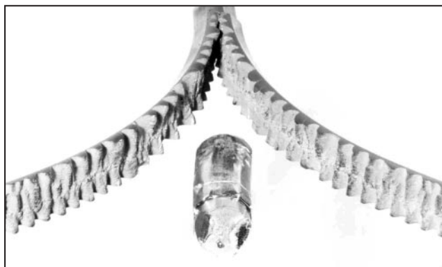
Figura 1 - Esempio di fenditura di laminazione in una barretta di lega d'oro durante la prima passata di laminazione (Per gentile concessione di Engelhard CLAL). Questa lega è dura ed è notoriamente difficile da lavorare
