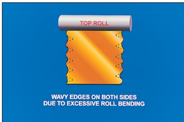
Figura 3 - Difetti dovuti alla flessione dei cilindri
