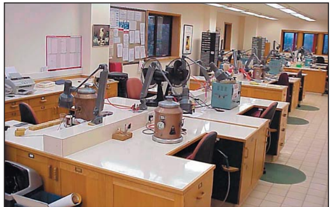
Figura 11 - Gruppo di 4 posti di lavoro. Le varie linee di alimentazione salgono dal pavimento fino al centro del gruppo
