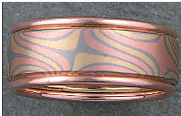
Figura 9 - Anello formato da oro giallo a 18 K, oro rosso a 14 K e oro bianco al palladio a 14 K
