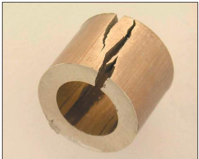
Figura 7 - Rottura a caldo in oro bianco al nichel
